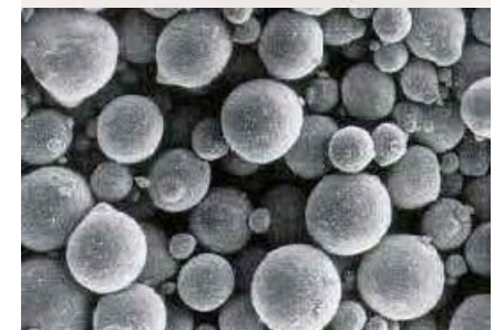
Rozmiar proszku 10 \mu\text{m} - 40 \mu\text{m}
